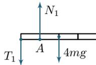
Найдём теперь минимальное значение массы жука  $M_{\min}$ , при котором ещё не проворачивается система из двух балок относительно оси, проходящей через т.  $B$ . По правилу моментов относительно указанной оси получаем  $T_1 \cdot 3l + 4mg \cdot l = 6mg \cdot l$ , где  $T_1 = M_{\min}g$ . Откуда  $M_{\min} = \frac{2}{3}m$ . Значит равновесие системы возможно при  $\frac{2}{3}m \leq M \leq 4m$ .
