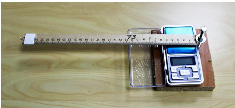
1. Произведите взвешивание винта М3 с гайкой сначала без усилителя, а потом с усилителем. Определите коэффициент усиления:
